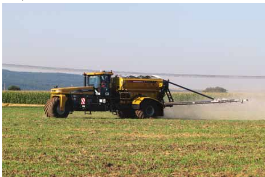
Vícekomorová variabilní aplikace pevných hnojiv strojem Challenger TG 8300
