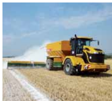
Pásmové vápnění prováděné strojem Challenger TG 2244
