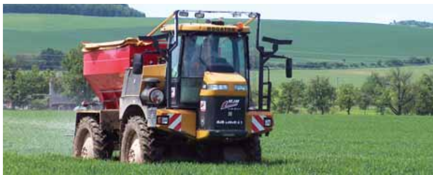
Challenger RoGator – variabilní aplikace pevných N-hnojiv
