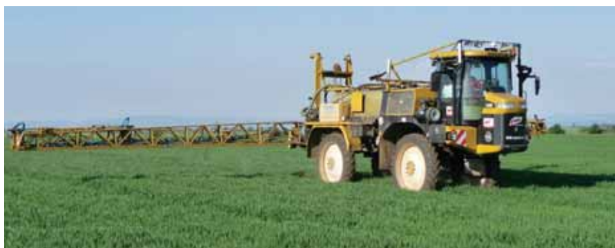
Challenger RoGator – variabilní aplikace kapalných N-hnojiv.
